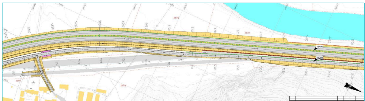
Figur 14 E6 og lokalveg ved eksisterende bebyggelse på Håggån. Eksisterende E6 og lokalveg fjernes og areal avsettes til dyrka mark.
